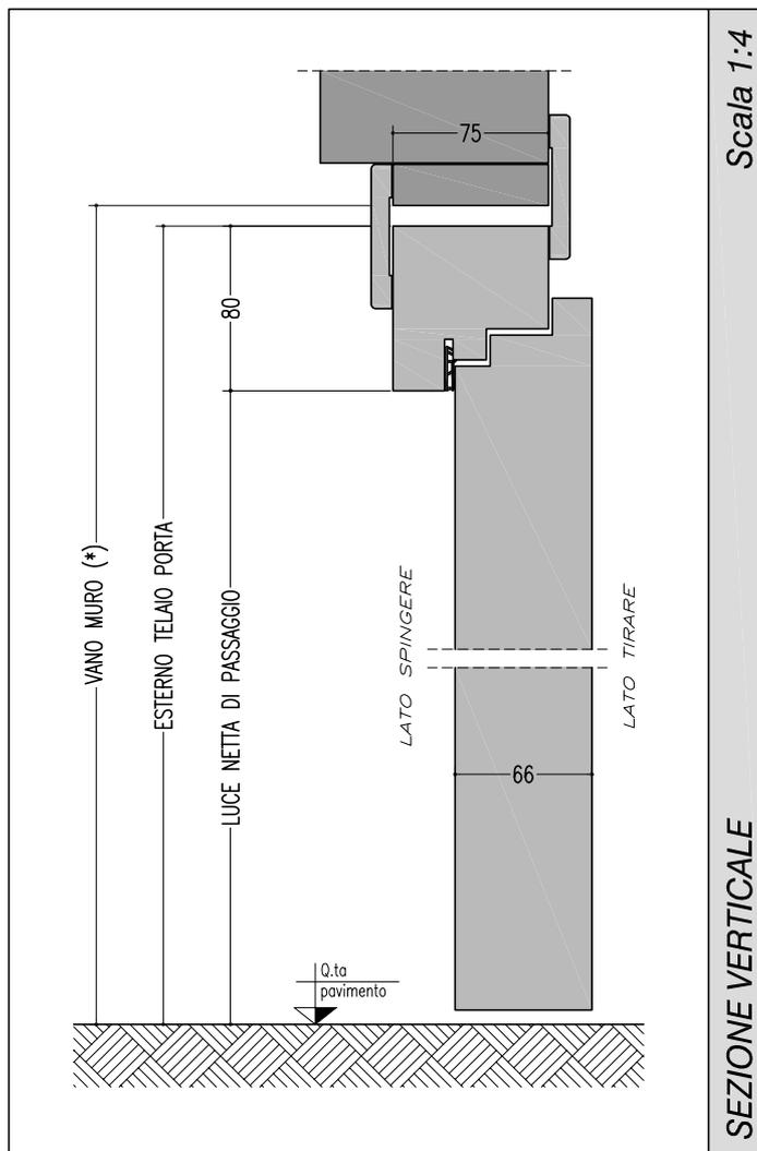
(\*) VANO MURO E' DA INTENDERSI COME INTERNO CONTROTELAIO
