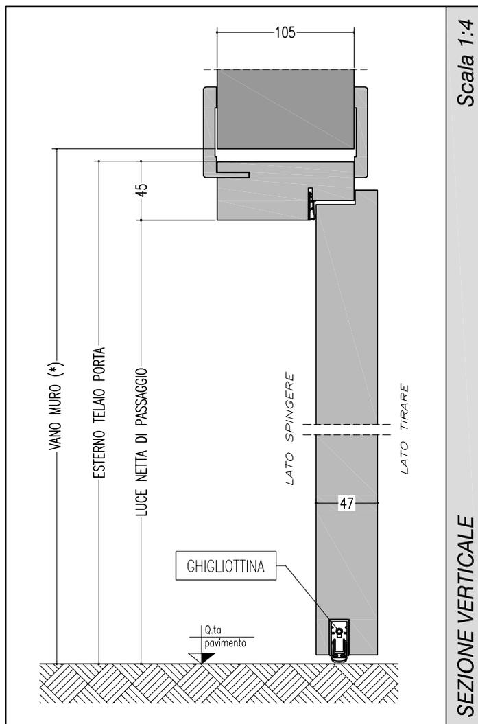
(\*) VANO MURO E' DA INTENDERSI COME INTERNO CONTROTELAIO OPPURE COME VANO CARTONGESSO
